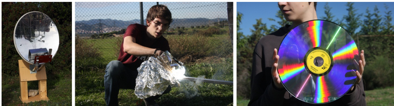
Figura 53. El filtre polaritzador no elimina els reflexos metàl·lics de la pantalla parabòlica (esquerra), del paper d'alumini (centre) ni del làser disc (dreta).
