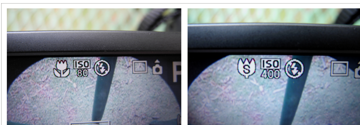
Figura 20. Detall ampliat del visor de pantalla de la càmera Canon SX20 IS per apreciar el símbol quan està seleccionada la funció macro (esquerra) i quan ho està la funció súpermacro (dreta) d'una mateixa càmera compacte.
