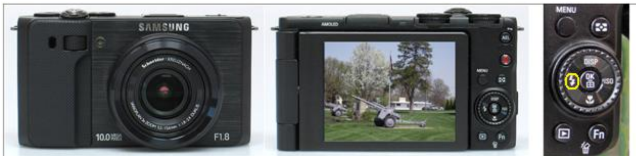
Figura 18. Càmera compacta Samsung EX1. Amb un detall ampliat (dreta) on s'assenyala la posició del botó per activar la funció macro.
