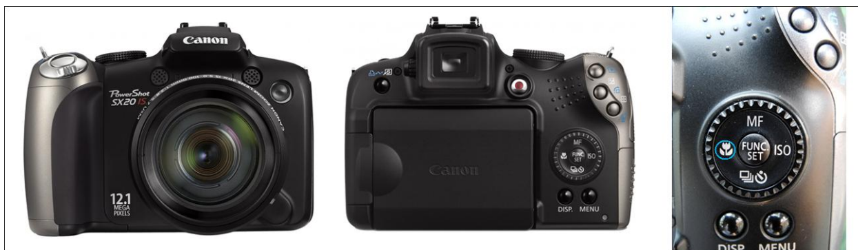
Figura 17. Càmera compacta Canon SX20 IS. Amb un detall ampliat (dreta) on s'assenyala la posició del botó per activar la funció macro.
