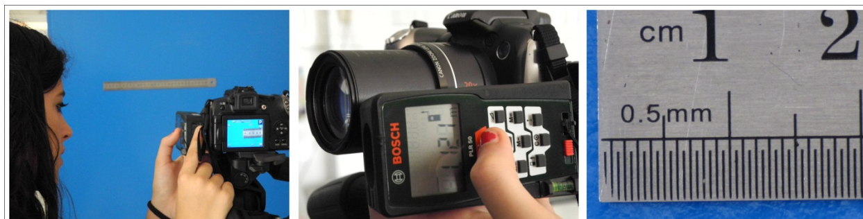
Figura 29. En aquestes 3 fotografies es mostra el procediment de com vam mesurar la distància mínima d'enfocament amb la càmera Canon SX-20 IS, per tal d'aconseguir el grau màxim d'ampliació, fent servir la modalitat teleobjectiu com a macro (vegeu apartat 4.1.4).
